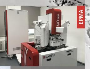
v súčasnosti predstavuje najmodernejší prístroj na nedeštruktívnu chemickú analýzu velmi malých objemov tuhých látok využívajúci zväzok urýchlených elektrónov. Okrem bodových chemických analýz (WDS) vykonávaných s priemerom elektrónového lúča 0,2 – 10 µm, prístroj poskytuje komplexnú plošnú alebo líniovú analýzu vzoriek pri zväčšení rádovo v jednotkách mikrometrov (BSE a SE obrazy, líniové profily, RTG mapy). Prístroj je doplnený energiovo-disperzný detektor (EDS) a
