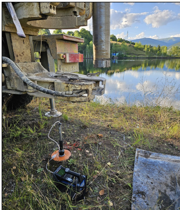
Terénne atmochemické meranie pôdneho vzduchu v novorealizovaných vrtoch
