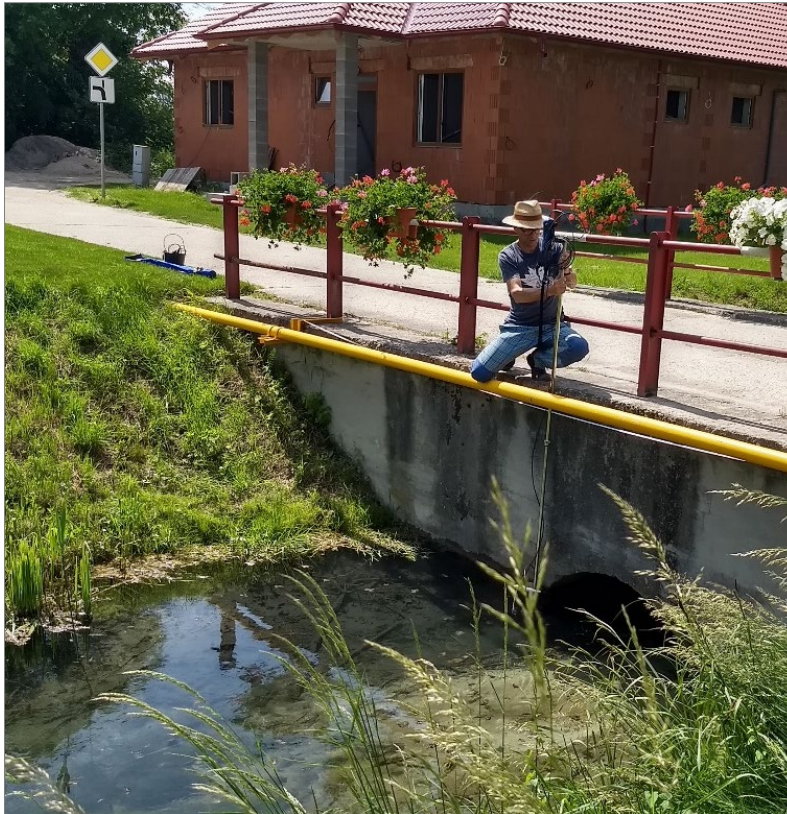
Hydrometrovacie práce - profil H165 v Bake
