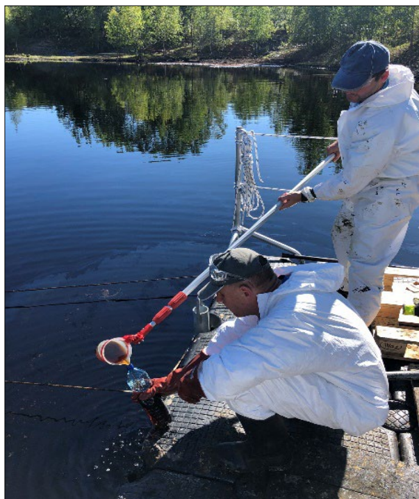
Odber vzorky kvapalnej fázy skládky pomocou odbernej nádoby uchytenej na teleskopickej tyči
