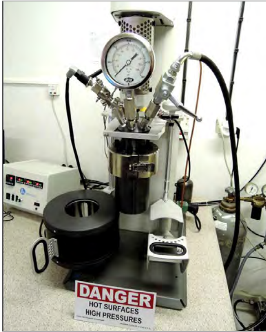
Vysokotlakový reaktor PARR 4540 umožňuje počítačovú registráciu reakčných parametrov (tlak, teplota, otáčky) a programovanie parametrov exotermických a endotermických reakcií.
