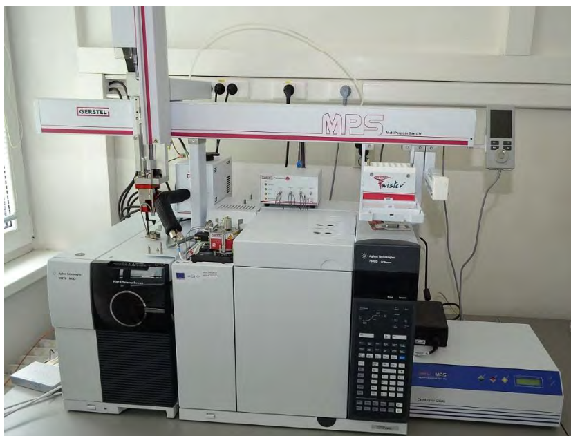
Plynový chromatograf Agilent Technologies 7890B GC System s hmotnostným spektrometrickým detektorom 5977B MSD
