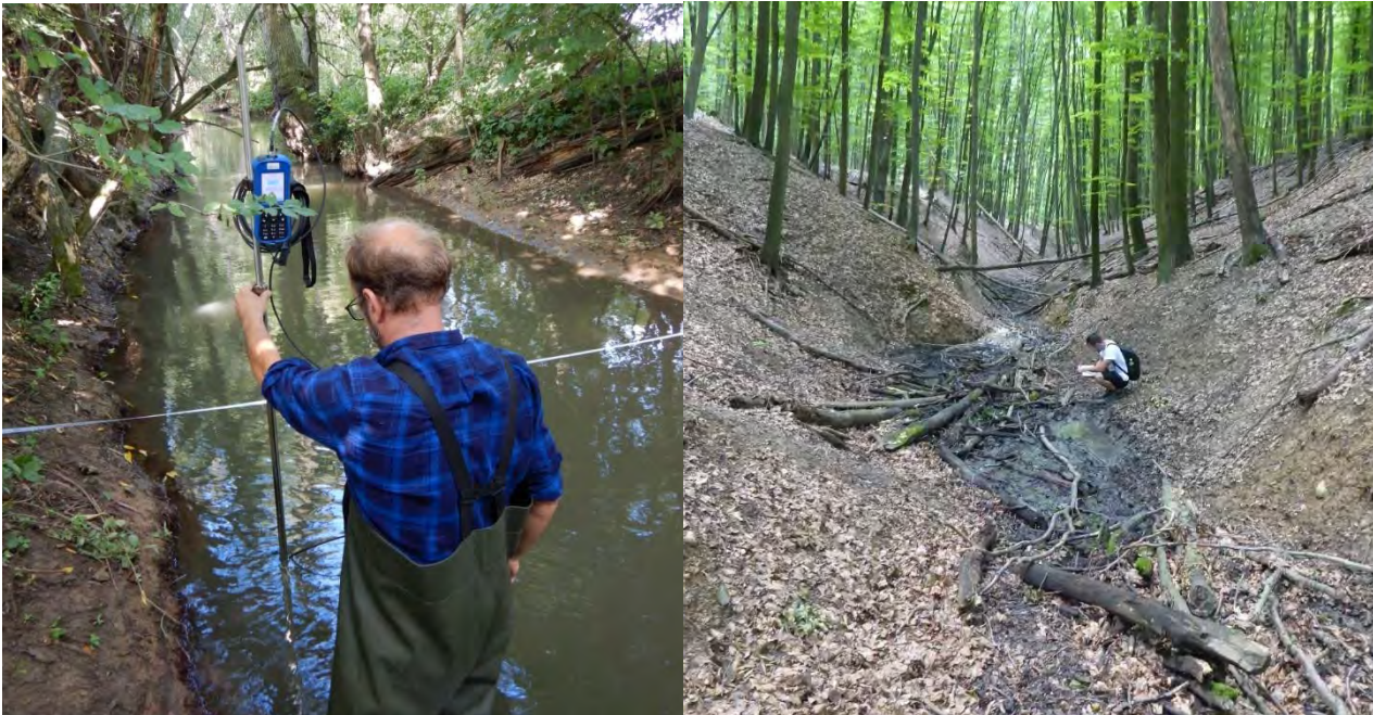
Trnavská pahorkatina – hydrometrovanie toku Hornej Blavy - meranie prietoku na profile HB-4 pomocou elektromagnetického prietokomeru OTT
